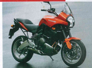
Dettagli da sportiva Il motore della Versys, derivato da quello della ER-6n, conserva il cambio di tipo estraibile. La forcella upside-down da 41 mm è regolabile nel precarico e nell'idraulica.
