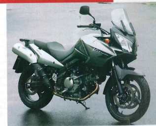
Tanta sostanza Il bicilindrico a 90° Suzuki è elastico e potente (81,95 CV alla ruota) e si esprime al meglio nei lunghi viaggi. La sospensione posteriore è regolabile nel precarico molla tramite un pratico pannello; per l'estensione la regolazione è nascosta e occorre sgorigliare le mani.
