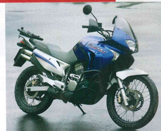
Classica fino all'osso Il Valvin Honda è omologato Euro 2 ed è risultato il meno potente dei lotto. Nel dettaglio: il foro nel fianco sinistro in cui inserire il cacciavite per regolare la compressione del monoammortizzatore. La forcella invece, con steli da 41 mm, è priva di regolazioni.
