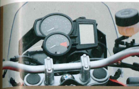
BMW: serbatoio sotto la sella A fianco: forme allungate e becco appropinquato per le enduro di Monaco. Il serbatoio è sotto la sella per abbassare il baricentro e permettere di fare rifornimento senza scendere dalla moto. Sopra: completa e ben leggibile, la strumentazione è composta da due elementi ovali (tachimetro e contagiri) e da un display digitale multifunzione.
