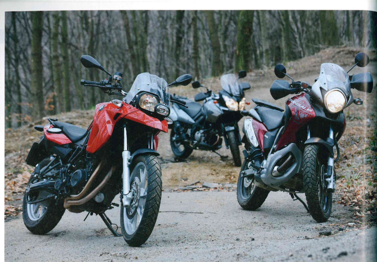
BMW: serbatoio sotto la sella A fianco: forme allungate e becco appropinquato per le enduro di Monaco. Il serbatoio è sotto la sella per abbassare il baricentro e permettere di fare rifornimento senza scendere dalla moto. Sopra: completa e ben leggibile, la strumentazione è composta da due elementi ovali (tachimetro e contagiri) e da un display digitale multifunzione.
