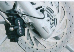
BMW: disco singolo da 300 mm. L'impianto manca un po' di mordente a pieno carico. L'ABS (optional a 800 euro) è disinseribile per la guida off-road.
