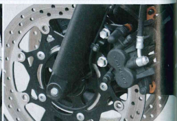
Suzuki: dimensioni da sportiva. La modulabilità dei dischi anteriori da 310 mm e del posteriore da 260 è buona, ma la leva deve essere strizzata con decisione.
