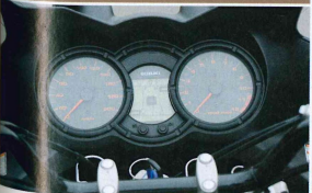
Suzuki: telaio in alluminio A destra: il telaio a doppia trave in alluminio è bello da vedere ed è il principale artefice della ottime doti dinamiche. Capiente ma voluminoso, il serbatoio da 22 litri garantisce grande autonomia. Sotto: La piana strumentazione è composta da due elementi analogici circolari e da un display multifunzione centrale. Ricca di informazioni, risulta però poco leggibile sotto il sole battente.
