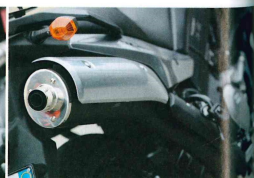
Suzuki: peccato per la pedana. Il terminale alto ha imposto di avanzare leggermente la pedana di destra del passeggero, unico neo in una posizione altrimenti perfetta.
